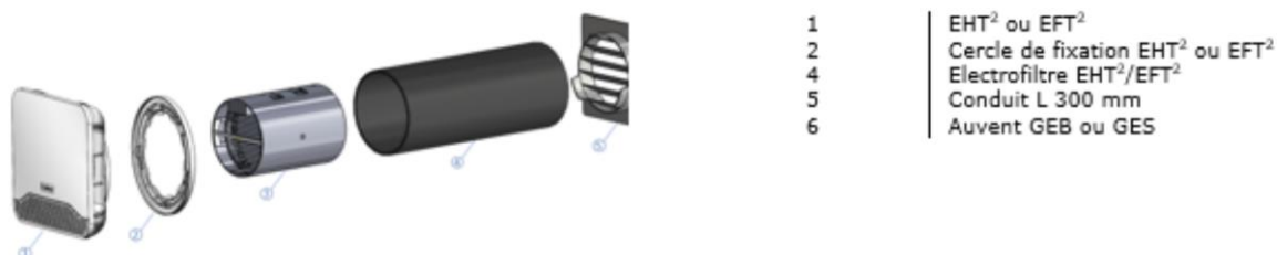
Figure 27 – Mise en œuvre entrée d'air EHT² ou EFT² avec électrofiltre EHT²/EFT² sans mousse Ø 125 mm L 300 mm
