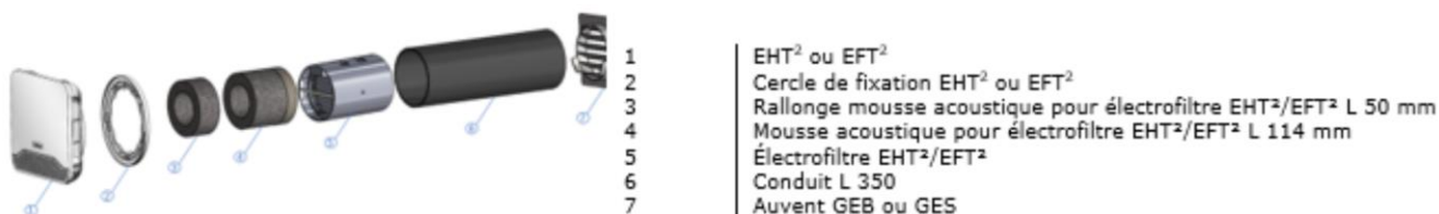
Figure 29 – Mise en œuvre entrée d'air EHT² ou EFT² avec électrofiltre EHT²/EFT² Ø125 mm L 350 mm
